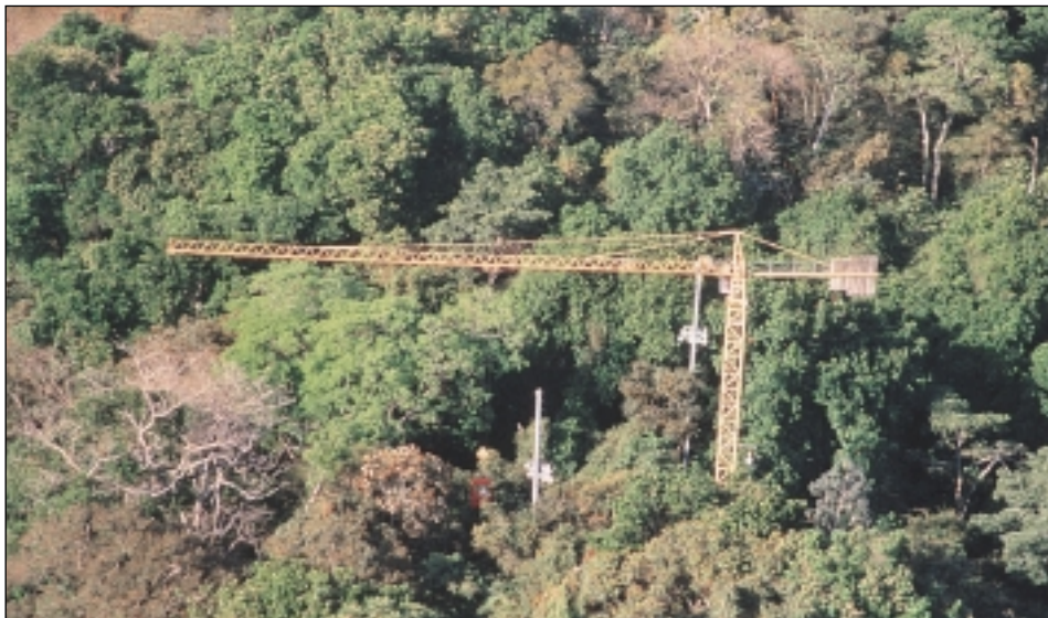
En 42 m høy bygningskran er reist i skogen i Metropolitan nasjonalpark i Panama av Smithsonian Tropical Research Institute (STRI). Kranas arm er 51 m lang, slik at 0,8 hektar skog kan studeres. Fra gondolen i kranen er alle ytre grener i de øvre sjikt av skogen lett tilgjengelige; dermed kan en studere artene der de lever.
